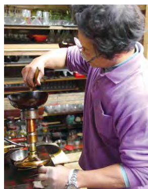
上)色や柄の趣向は時代とともに変化しても、変わらず受け継がれるのが手回し器による塗りの技法。
